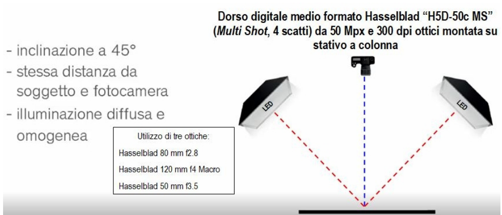
Fig. 23: schema a due luci applicato all’installazione di un dorso digitale medio formato Hasselblad “H5D-50c Multi Shot” da 50 Megapixel, risoluzione ottica di 300 dpi (e dettaglio delle tre diverse ottiche utilizzate), presso il “Laboratorio fotografico” della Veneranda Biblioteca Ambrosiana
